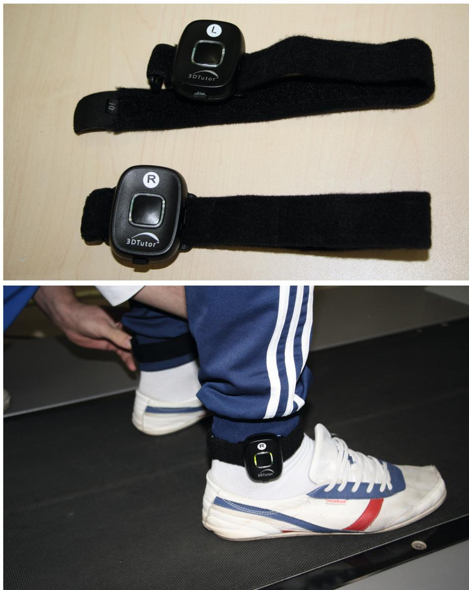
Рис. 2. Съёмные датчики движения и их фиксация на нижние конечности
